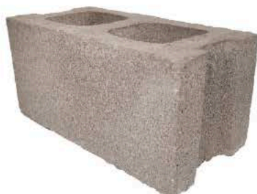
Bloque Concreto 10 y 13 Mpa (kg/cm 2 ) Color: Gris Medida: 20x20x40cm Und/m 2 : 12.5 Peso: 18 kg Bajo pedido 8-15 días
