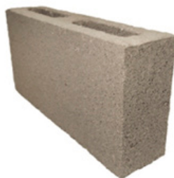
Bloque Concreto 10 y 13 Mpa (kg/cm 2 ) Color: Gris Medida: 8x20x40cm Medida: 10x20x40cm Und/m 2 : 12.5 Peso: 9, 10 kg Producción 8-15 días
