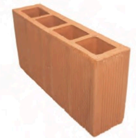
COCO #4 Rayado Vertical Color: Natural Medida: 10x20x40cm Und/m2: 12.5 Peso: 6.5 Kg Producción 8 días
