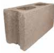
Bloque 15x20x40 Color: Gris concreto Medidas: 15x20x40cm Und/m 2 : 12.5 Peso: 13 Kg
