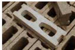
Bloque arquitectónico Color gris, arena, ocre, terracota Medida 15X8X48 Und/m 2 : 26 Peso: 6 kg Superficie: corrugada
