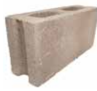
Bloque 12x20x40 Color: Gris concreto Medidas: 12x20x40cm Und/m 2 : 12.5 Peso: 12 Kg
