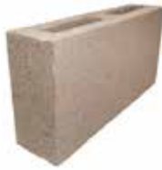
Bloque 10x20x40 Color: Gris concreto Medidas: 10x20x40cm Und/m 2 : 12.5 Peso: 10.5 Kg
