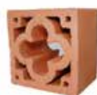
Calado muro 15 Color: natural Medidas: 20x15x20cm Und/m 2 : 25 Peso: 5.4 Kg
