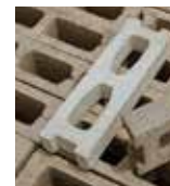
Bloque arquitectónico Color gris, arena, ocre, terracota Medida 15X6X42 Und/m 2 : 39.7 Peso: 5 kg Superficie: corrugada
