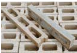
Bloque arquitectónico Color: gris, arena, ocre, terracota Medidas: 6X12X60 Und/m 2 : 12.5 Peso: 17 kg Superficie: corrugada
