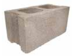
Bloque 20x20x40 Color: Gris concreto Medidas: 20x20x40cm Und/m 2 : 12.5 Peso: 17.5 Kg
